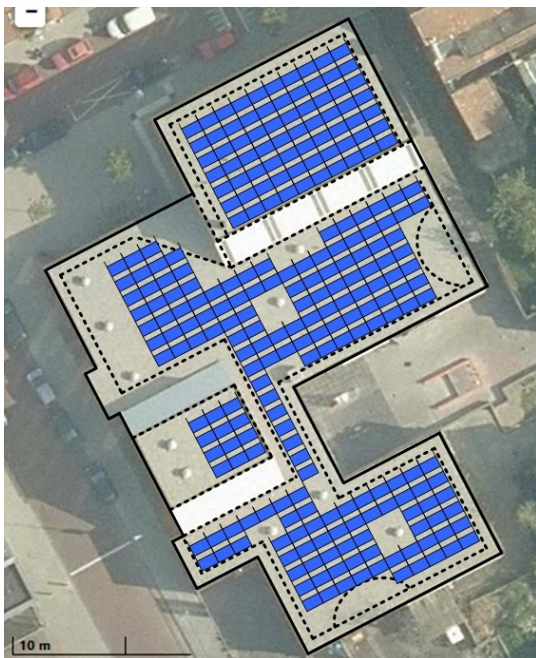
Weergave van de te realiseren zonnepanelen
